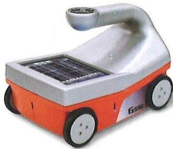
電磁波レーダ法装置
